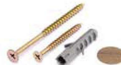
Kit ferragem para fixação de painéis em parede 8 parafusos cabeça chata zincados 4,5x50mm, 8 parafusos cabeça chata zincados 5x80mm, 8 buchas para concreto e 8 adesivos tapa furo.
